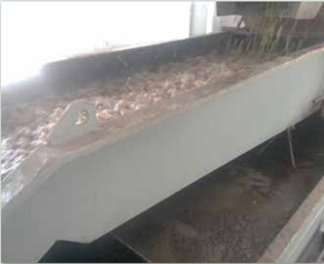
Ο μαλακτήρας είναι ένα σημείο στο ελαιοτριβείο όπου η ελαιόπαστα έρχεται σε επαφή με μεταλλικές επιφάνειες
